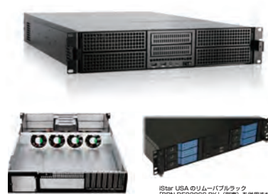
iStar USAのリムーバブルラック [BPN-DE230SS-BK] (別売) を併用すれば 3.5インチ SATA HDDが6台搭載可能
